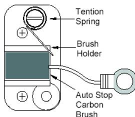
Поради новите графитни четки с авто стоп, ако машината спре без причина, четките трябва да се проверят. Автоматичната характеристика спира машината, преди графитните четки да се свършат и защитава мотора.
